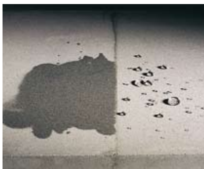
Questa pietra Serena è stata per metà trattata con i prodotti Fila e metà no. Nella parte trattata, a destra, si nota il particolare effetto goccia dell'acqua. Nella parte non trattata l'acqua penetra nel pavimento
